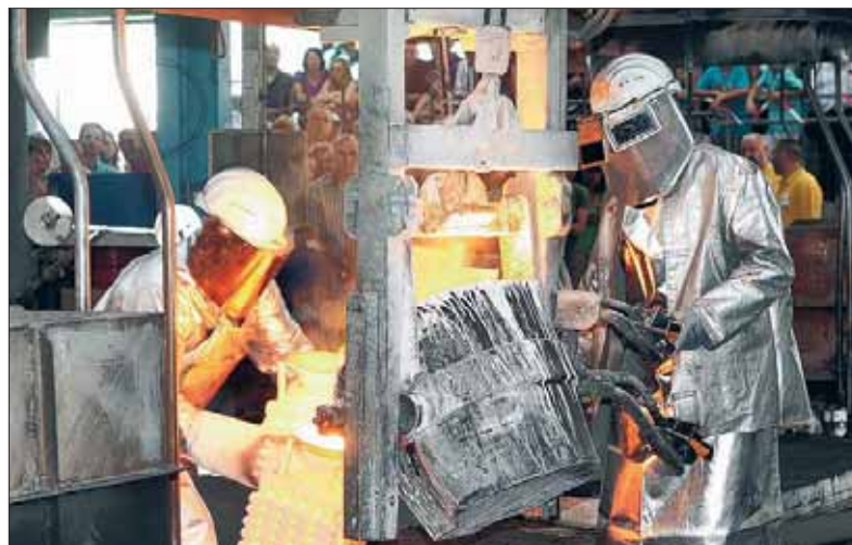
Blank-Mitarbeiter in „spaciger“ Schutzkleidung gießen die flüssige, 1600 Grad heiße Schmelze in glühende Keramikschalen ein.
