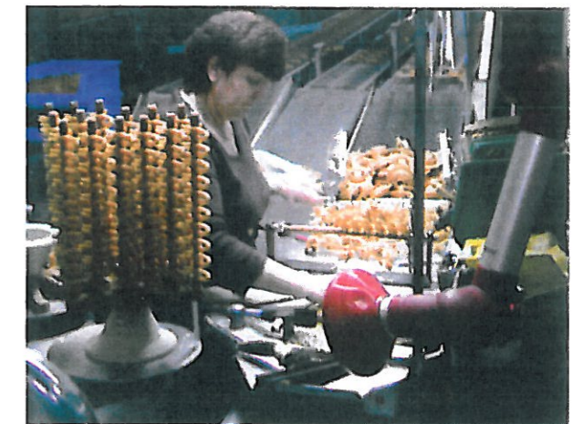
Die mit Spritzgießmaschinen hergestellten Wachsmodelle werden per Hand zu Wachsträumen zusammengefügt.
