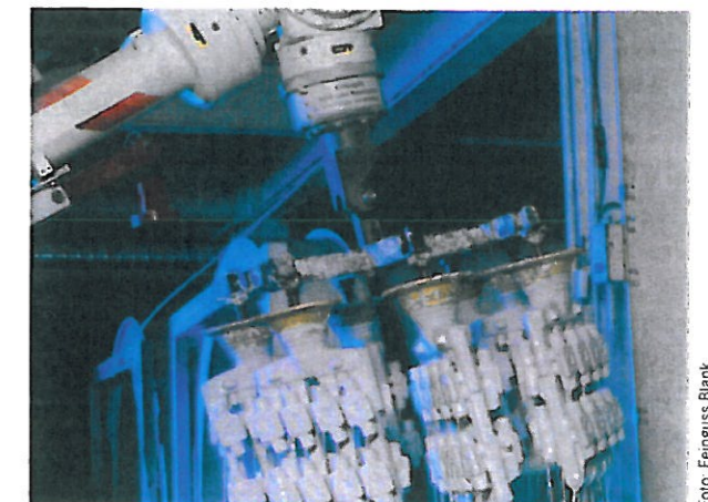
Wachstraube wird im Tauchraum mit einer keramischen Beschichtung überzogen.
